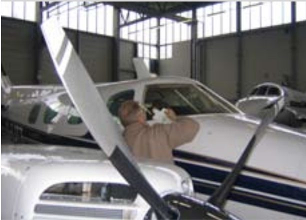
Diese Duke tankt Jetfuel. Der Centurion 4.0 ist für Jet-A1 zugelassen (kein Autodiesel). Mitte: Unmittelbar vor dem Erstflug hält Martin Hagensieker noch einmala Zwiesprache mit seinem Dieselbaby. Unten: Einen V8 und 8 Kühler unter die unveränderte Cowling der Duke zu kriegen ist die Leistung der Firma Gomolzig.
