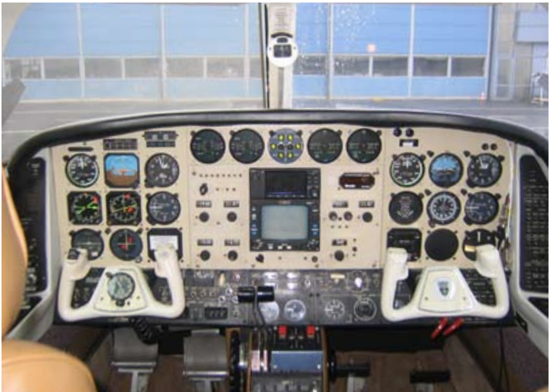
Im Cockpit der Duke lösen Einhebelbedienung und moderne digitale Triebwerksinstrumente den klassischen „Sechser“ mit den vielen teils recht eigenwilligen Triebwerksinstrumenten ab.
