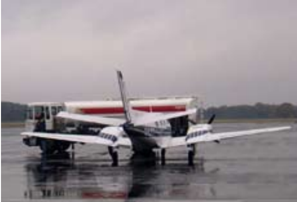
Diese Duke tankt Jetfuel. Der Centurion 4.0 ist für Jet-A1 zugelassen (kein Autodiesel). Mitte: Unmittelbar vor dem Erstflug hält Martin Hagensieker noch einmala Zwiesprache mit seinem Dieselbaby. Unten: Einen V8 und 8 Kühler unter die unveränderte Cowling der Duke zu kriegen ist die Leistung der Firma Gomolzig.
